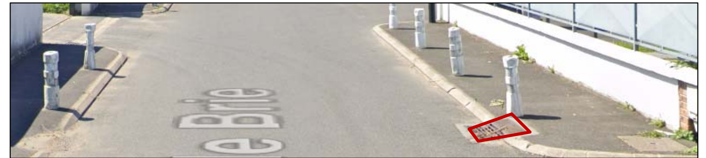
Figure 8: Grilles d'évacuation des eaux pluviales le long de la route de Brie (Google Maps, 2020)
